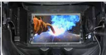
► **Flip-Up System:** Kassette wird im Helm hochgeklappt, um z. B. beim Schleifen direkt durch die klare Schutzscheibe schauen zu können
