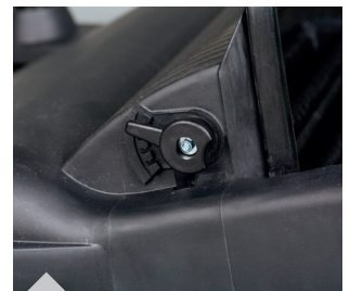
Einfache und werkzeuglose Höhenverstellung der Kehrwalze
