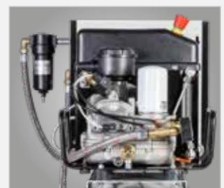
Feinfilter als Vorfilter vor dem Kältetrockner zum Abscheiden von Kondensat und festen Verunreinigungen mit Partikeln bis 1 µm (Druckluftqualität nach ISO 8573-1)
