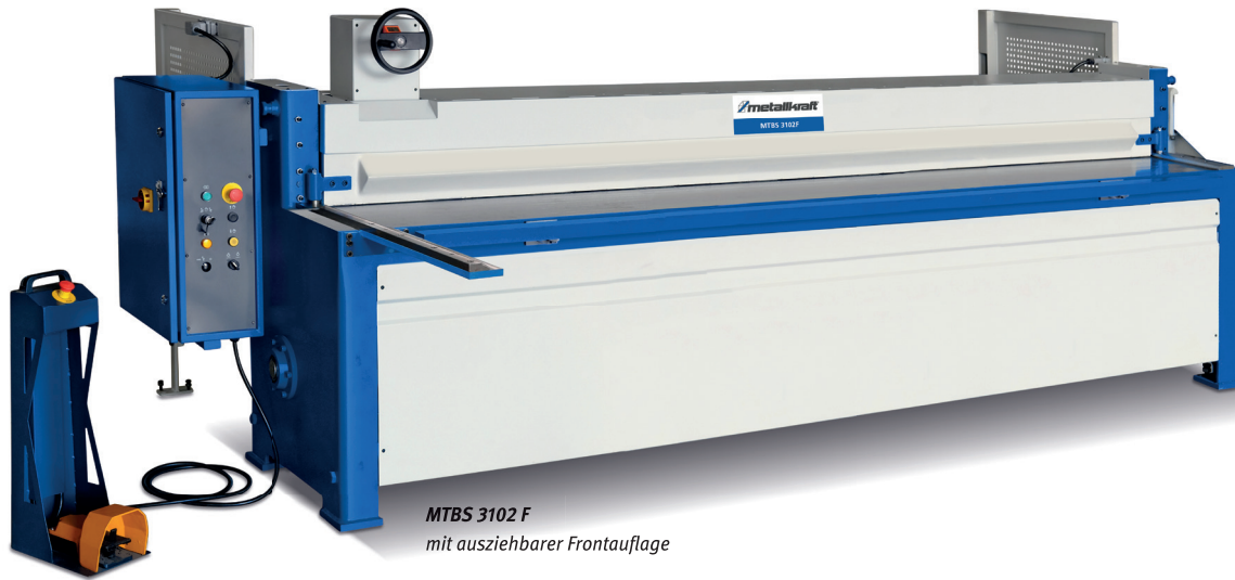
▶ Rückraum durch Lichtschranke abgesichert
