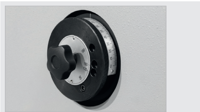
serienmäßige Steuerung MA – manuelle Verstellung des Biegewinkels mittels Skalenring an der linken Maschinenseite
