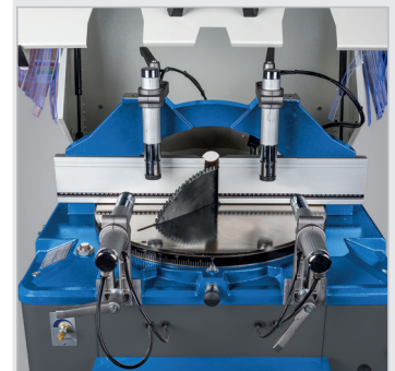
▶ Serienmäßig mit vier pneumatischen Spannzyklindern
