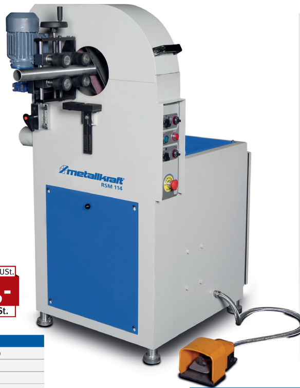
▶ Zwei entgegengesetzt laufende Schleifbänder auf rotierendem Kopf, das Verdrehen des Werkstücks entfällt
