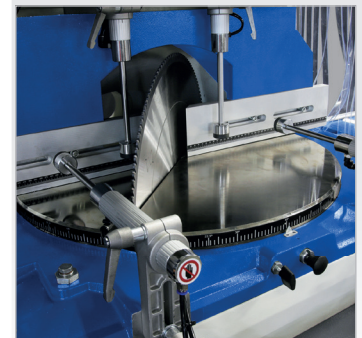
▶ Stufenlose Verstellung des Gehrungswinkels
