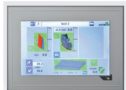
▶ Bedienung der Maschinenfunktionen über 8“ Touchscreen
