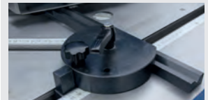
► Exakte Winkeleinstellung mithilfe von Anschlägen und Skalen
