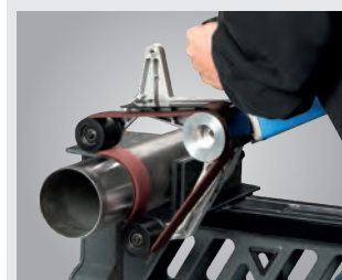
► Nur zwei Arbeitsschritte notwendig für 360° Umfangschleifen
