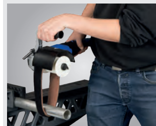
► Satinieren von Rundstahl mit Klettvlies auch bei z.B. bereits montierten Edelstahlgeländern
