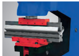
► Optionale Abkantvorrichtung für Flachstahl (ab HPS 45S erhältlich)
