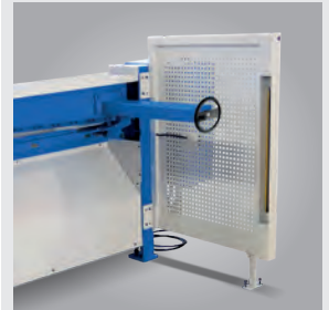
▶ Rückraum durch Lichtschanke abgesichert
