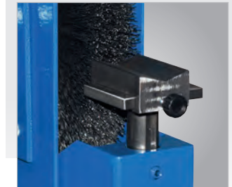
▶ Mit verstellbarer Prismen Werkstückauflage
