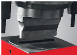
► Optionale Stanzeinrichtung für große Durchmesser
