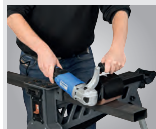
► Satinieren von flachem Material
