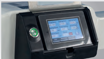
▶ Einstellung der Parameter über im Schwenkarm integrierten Touchscreen
