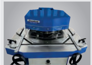
► Eingriffsbereich geschützt durch Schutzhaube
